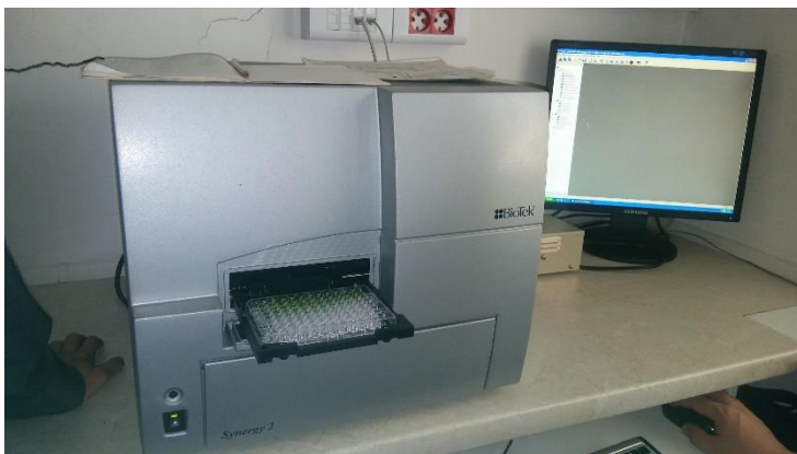
Fot. 4. Mikropłytki z próbkami oraz czytnik (Biotek).
